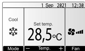
La temperatura se baja con **F2** y se sube con **F3**
