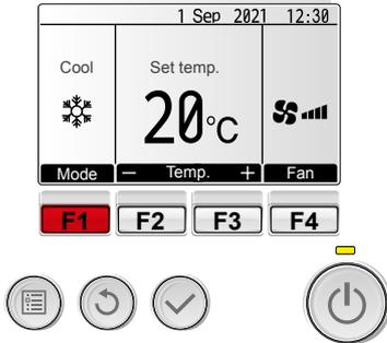
Presione el botón [F1] para ver los modos de operación en el orden de: "Cool" (Frio), "Dry" (Secar), "Fan" (Ventilación), "Auto" y "Heat" (Calor). Seleccione el modo de funcionamiento deseado.
