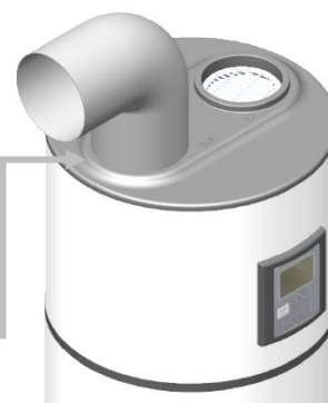
Tubo Ø190 encaja en la parte exterior
